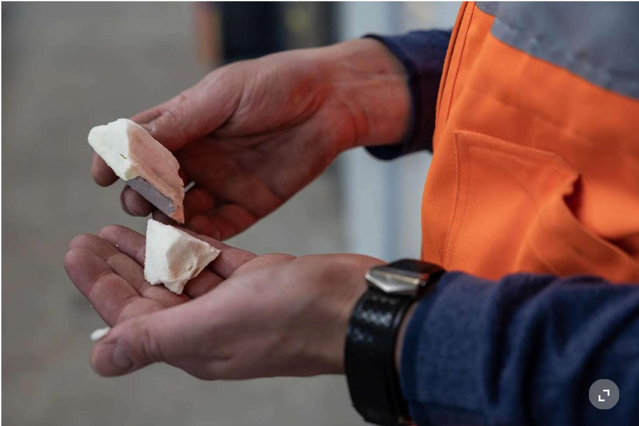
Die Isolation älterer Kühlgeräte enthält Gas. In der Recyclinganlage in Aarwangen kann dem Schaumstoff das Gas entzogen werden.
