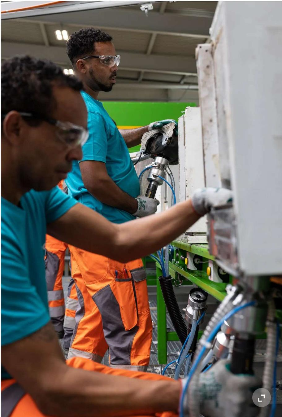
Mit einem Spezialbohrer werden den Kompressoren, die es zur Kühlung der Geräte braucht, Gas und Öl entzogen.
